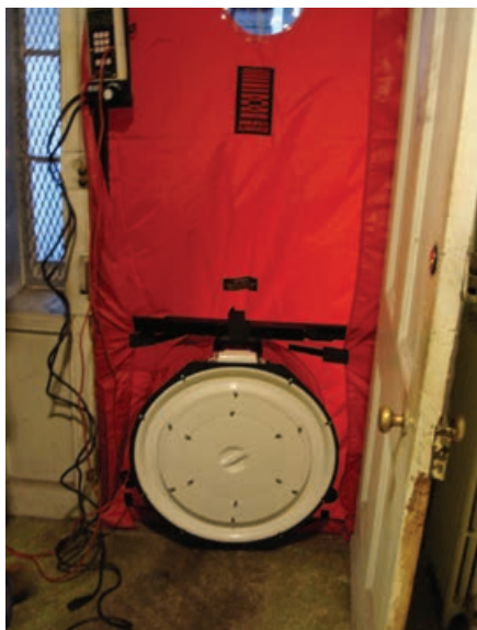
Blower door test.
